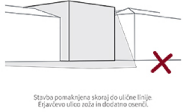
Stavba pomaknjena skoraj do ulične linije. Erjavčeva ulica zoža in dodatno osenči.
